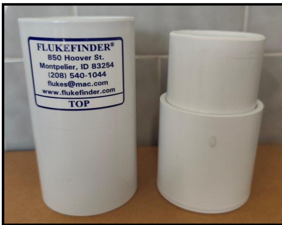
Слика 5. Раздвојене горња и доња јединица Flukefinder апарата
